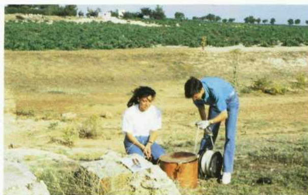
Fig. 3.— Medición del nivel del agua en un pozo en La Mancha. (Foto: M. R. Llamas, 1995).
