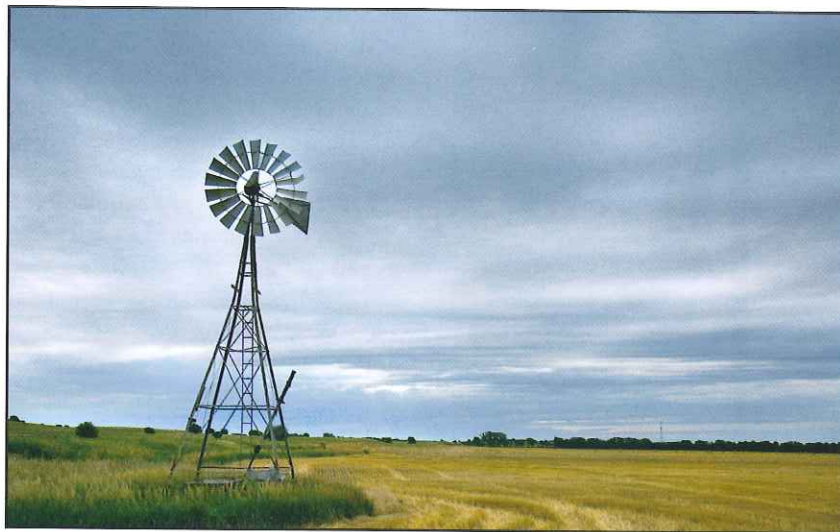
Molino de viento para elevar aguas subterráneas para uso agrícola.
