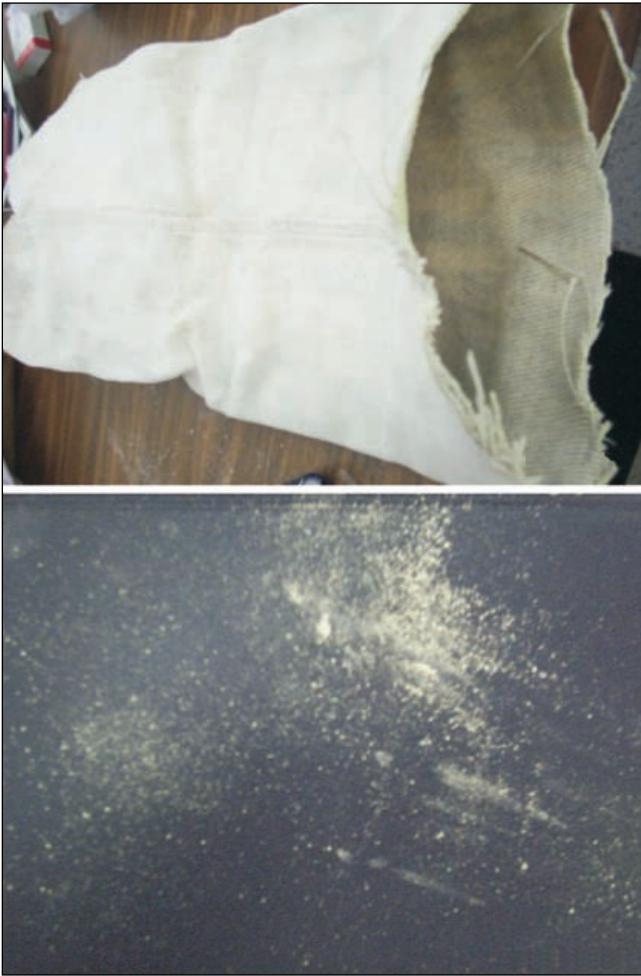
Figura 4. Filtro de mangas y cenizas volantes retenidas.
